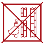
недостаточная тяга (Не используйте котел!)
