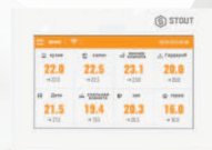
M-7 ПРОВОДНАЯ КОНТРОЛЬНАЯ ПАНЕЛЬ STE-0101-007003/STE-0101-007004
