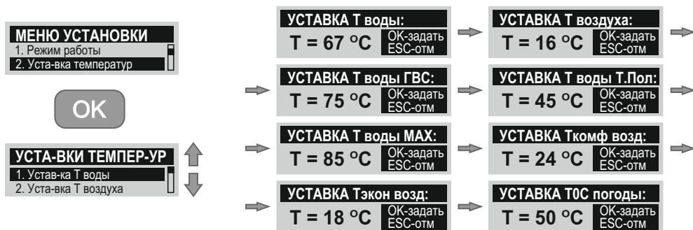
Рисунок 22. Установка температурных параметров
